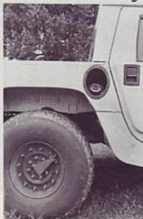
Kolo z napeljavo za tlačenje (in spuščanje) zraka v gumo, poklopec posode za gorivo
