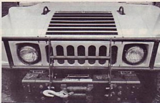
Nos in oprema: dvizna kavlija, zaščitne cevi, vitlo (s škatlama za verige ob straneh)
